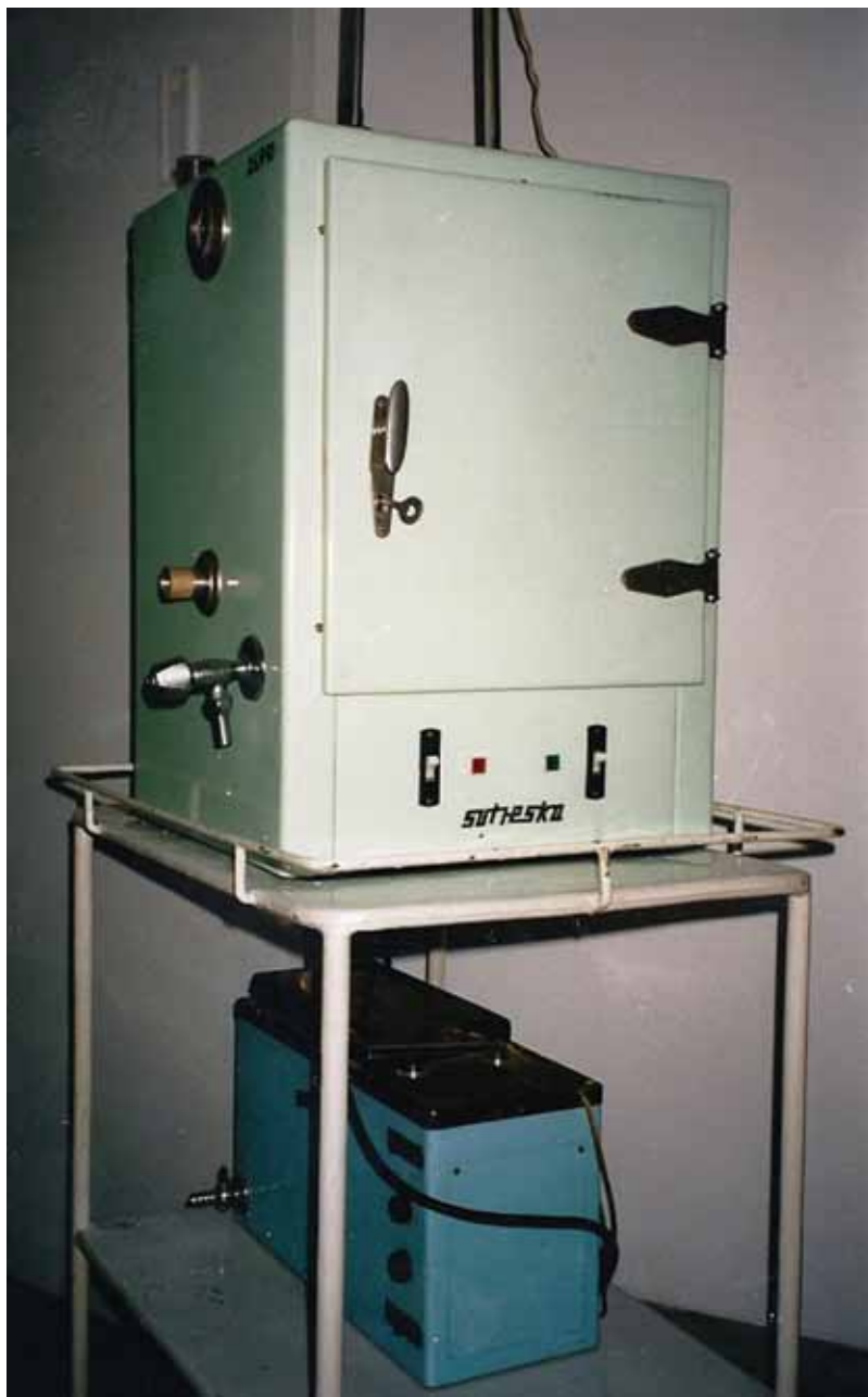
Slika 1: Posnetek prvega inkubatorja za IVF. Predelan Sutjeska termostat v mariborskem centru.
