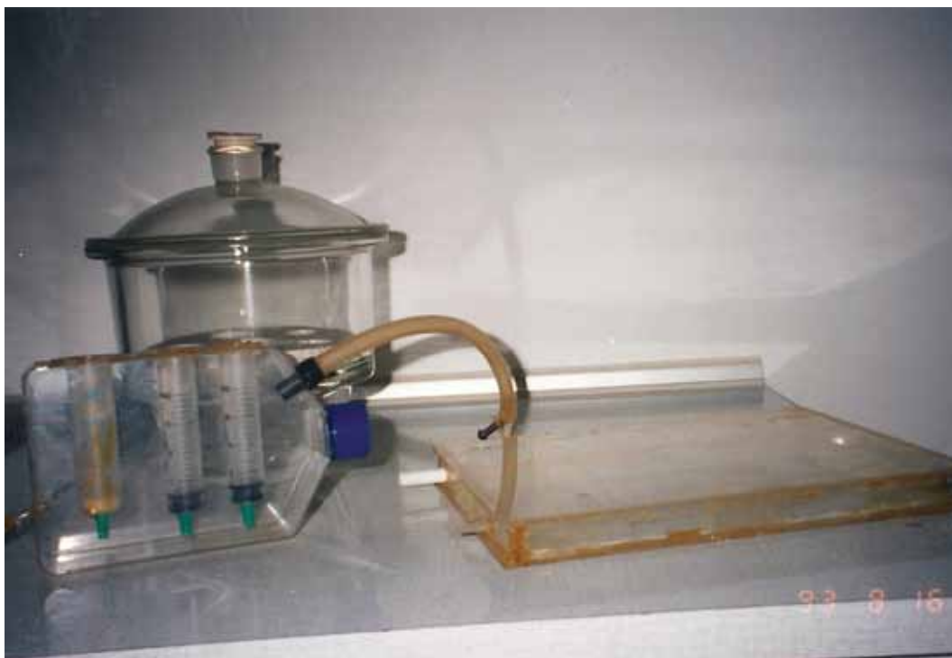
Slika 2: Posnetek notranje opreme prvega inkubatorja za IVF. V njem sta bili nameščena stekleni eksikator in grelna plošča lastne izdelave.
