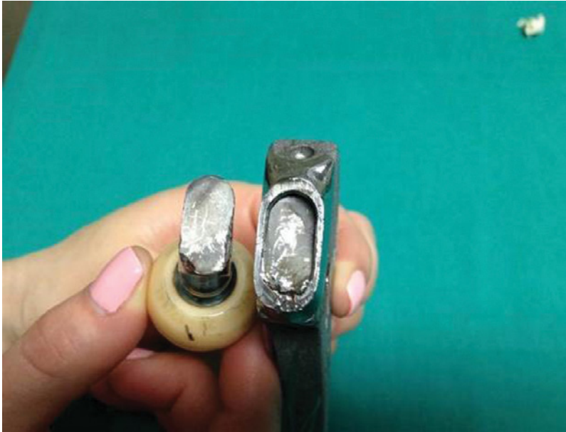
Slika 2: Zlomljen izmenljivi vrat endoproteze. Distalni del vratu je še zagozden v ženskem delu Morsejevega konusa debla endoproteze.
