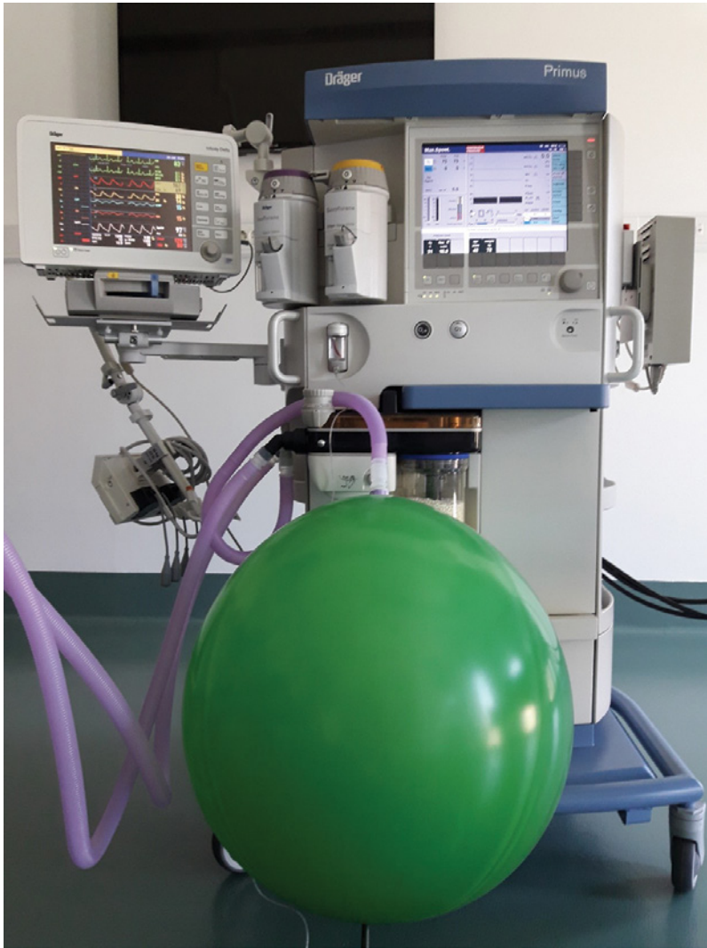
Slika 4: Varnostna funkcija balona – vzdrževanje konstantnega tlaka v dihalnem sistemu (primer na sliki: tlak znotraj balona: 34 cm H 2 O, premer balona: 66 cm, prostornina balona: 150 litrov).
