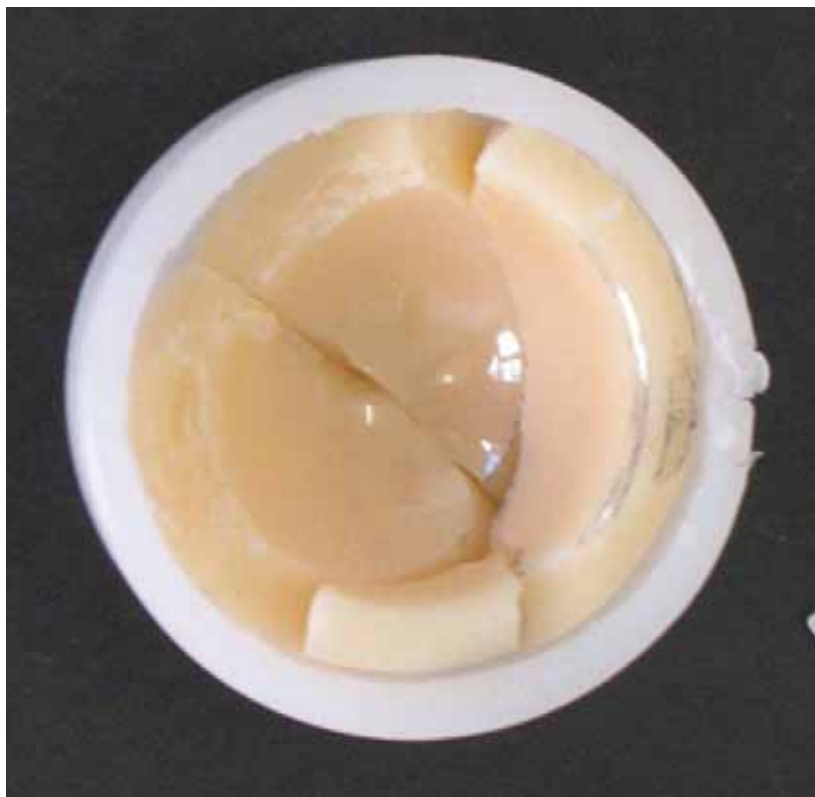
Slika 3: Primer zlomljenega keramičnega vložka proteze z obremenilnim sklopom keramika-na-keramiko.
